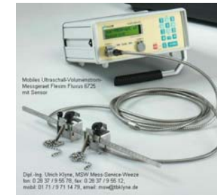
Fluxus® ADM 6725 von Flexim mit clamp-on-Sensor
