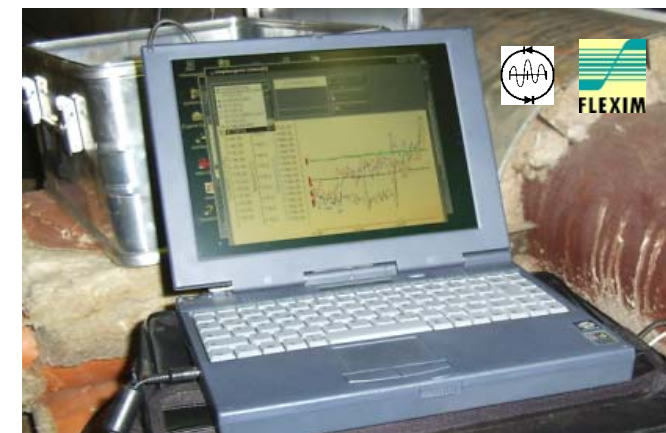
Auslesen der Daten mit Laptop über die Messdaten-Windows-Software FluxData®
