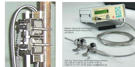
Fluxus ® ADM 6725 mit clamp-on-Sensor von aussen messen, was innen fließt
