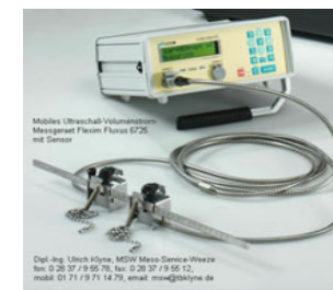
Fluxus ® ADM 6725 mit clamp-on-Sensor von aussen messen, was innen fließt
