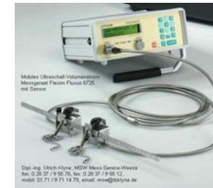
Fluxus ® ADM 6725 mit clamp-on-Sensor von aussen messen, was innen fliesst
