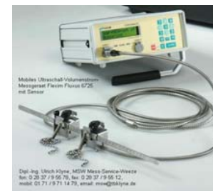
Fluxus ® ADM 6725 mit clamp-on-Sensor von aussen messen, was innen fliesst
